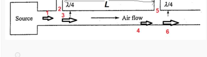
$$\left\{ \begin{array}{l} p_1 \\ v_1 \end{array} \right\} = \begin{bmatrix} 1 & 0 \\ \frac{1}{-jY_t \tan k_0 L} & 1 \end{bmatrix} \begin{bmatrix} \cos k_0 L & jY_c \sin k_0 L \\ \frac{j}{Y_c} \sin k_0 L & \cos k_0 L \end{bmatrix} \begin{bmatrix} 1 & 0 \\ \frac{1}{-jY_t \tan k_0 L} & 1 \end{bmatrix} \begin{Bmatrix} p_6 \\ v_6 \end{Bmatrix}$$
