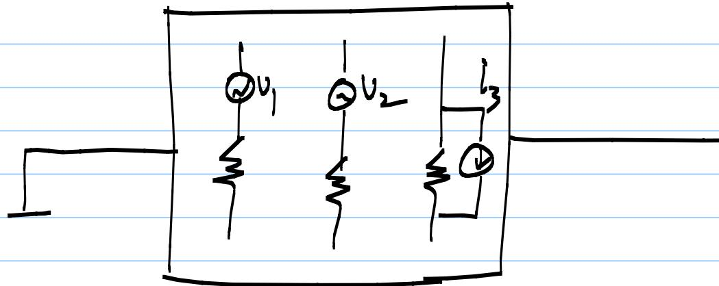
$$V_o = V_1 \cdot H_1(f) + V_2 \cdot H_2(f) + I_3 \cdot H_3(f) + \dots$$
