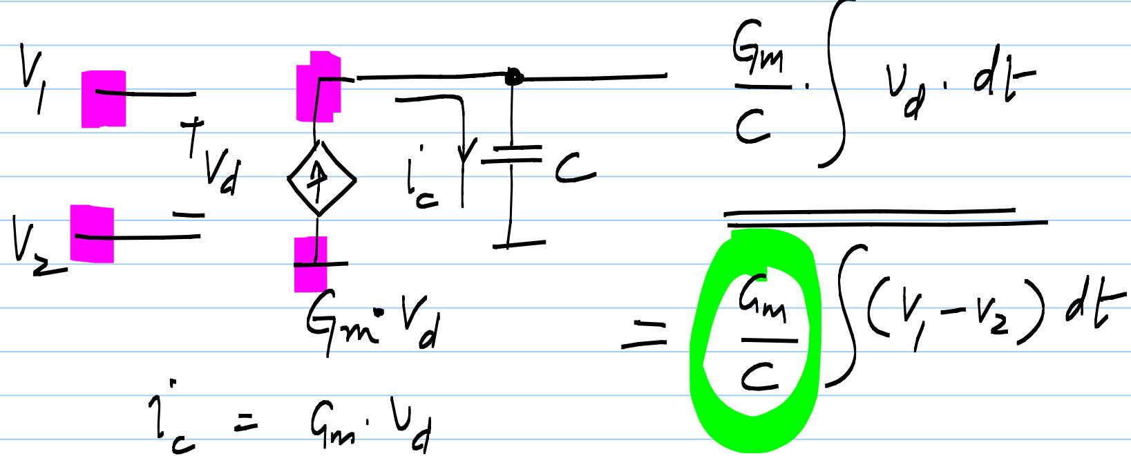
$$= \frac{G_m}{C} \int (V_1 - V_2) dt$$
