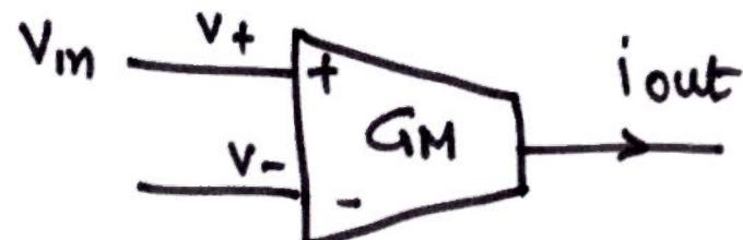
$$i_{out} = G_M \cdot (V_+ - V_-)$$
